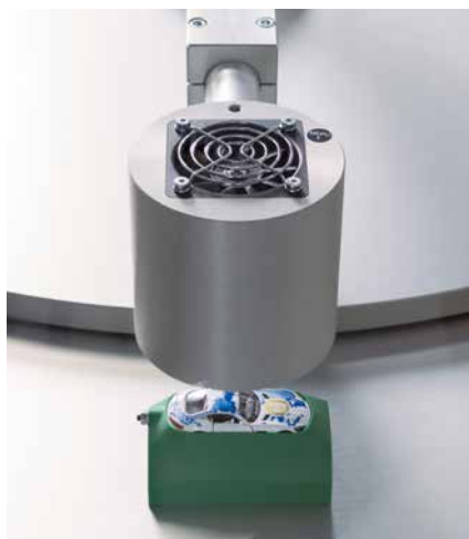
Secado por aire frío de componentes – secado sencillo de la tinta de tampografía para una impresión ulterior más rápida
