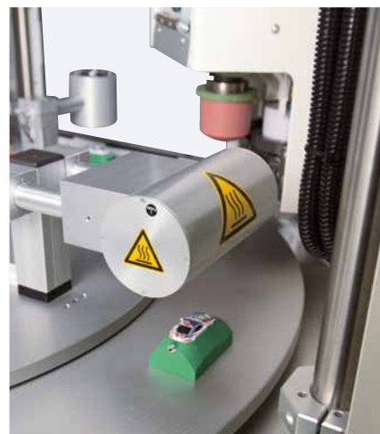
Secado de componentes por infrarrojos – reduce el tiempo de secado de la tinta de tampografía
