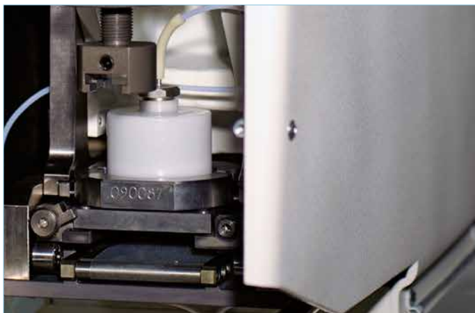
Abb.: Befestigung von Ablaufschlauch (8) mittels Verschlussstopfen (11) an Farb-/Rakeltopf (12)
