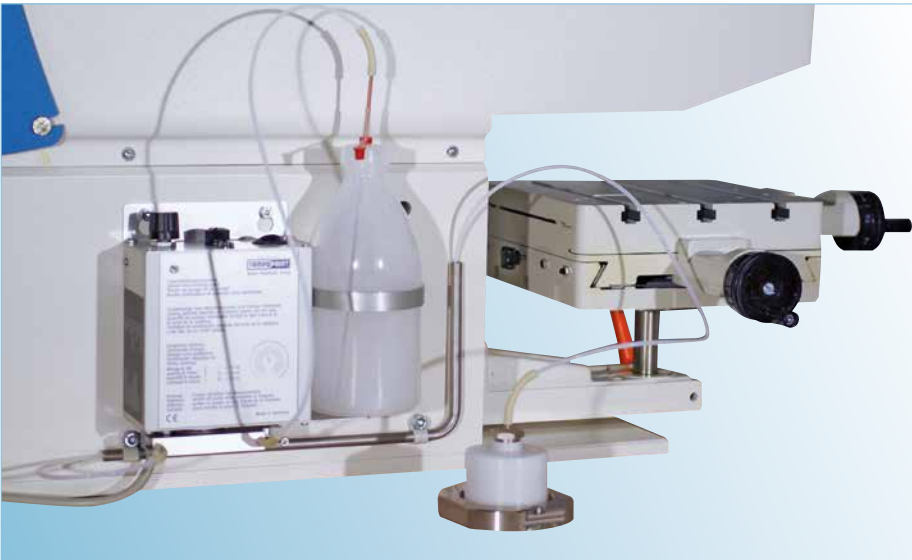
Abb.: Beispiel Montage Verdünnner-Dosiersystem „hermetic“ an Tampondruckmaschine
