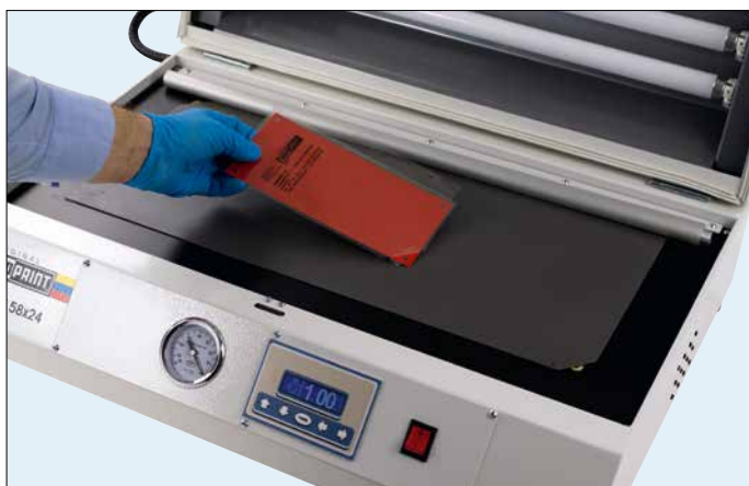
Auflage von Klischee, Filmmontagefolie und Film auf den Bestrahlungstisch
